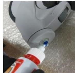
**Achtung: der Schraubensicherungslack muss mindesten 3 Stunden trocknen
