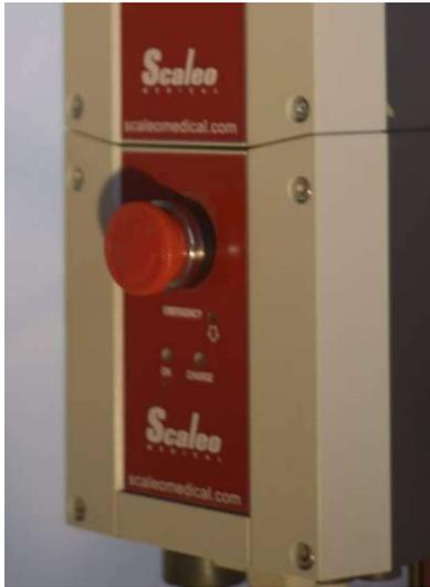
Der Shado® E ist mit einem 24-V-Akkupaket und den Nutzer schützenden Sicherheitskomponenten ausgerüstet:
