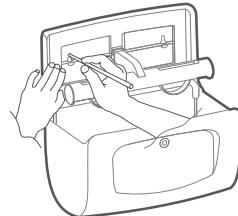
2. Bohrlöcher bohren und Dübel einsetzen.
